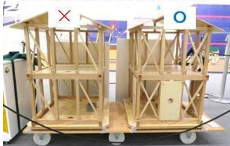
昭和56年に建築法に耐震構造を制定され、左は導入前、右は導入後の構造となっています。
